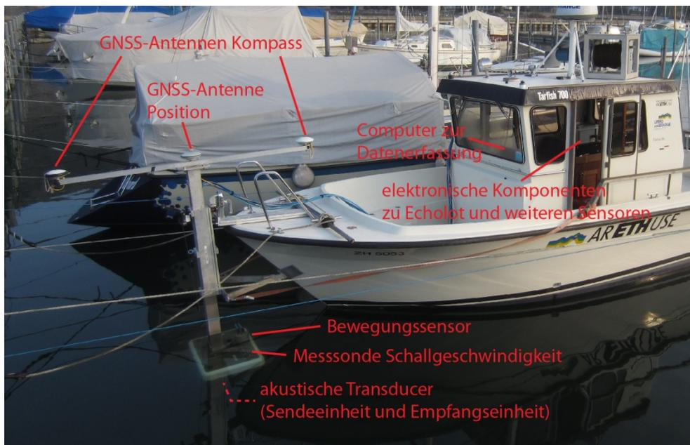
Abbildung 3: Messboot „Arethuse“ mit installiertem Fächerlotsystem im Kleinboothafen Biel. Wesentliche Komponenten des Systems sind bezeichnet.
