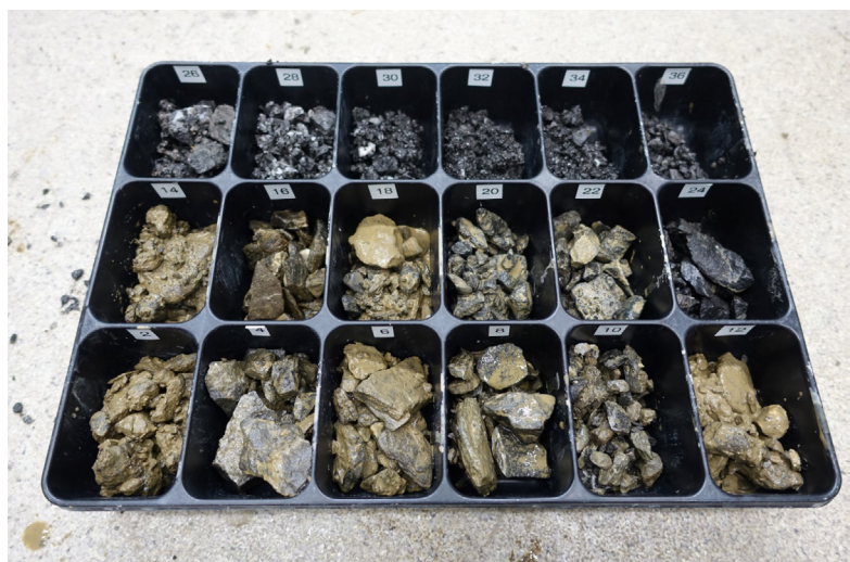
Bohrgut (Cuttings) einer destruktiven Bohrung. Proben wurden nach jeweils 2 m Bohrfortschritt entnommen; daraus wird das Bohrprofil erstellt. Bild: Baustofflabor, Uetendorf
